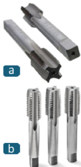
3.22 pav. Sriegiklių komplektai rankiniam sriegimui: a) dviejų sriegiklių komplektas dviem praėjimams, b) trijų sriegiklių komplektas trims praėjimams (Thürmer Tools)
