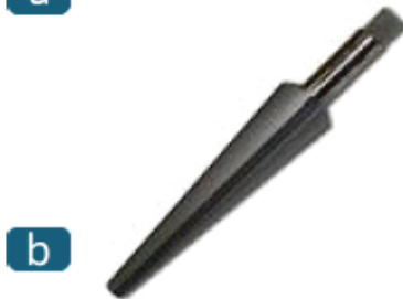
3.20 pav. Plėstuvai: a) cilindrinė skylių plėtimui, b) kūginių skylių plėtimui (Gehring Technologies GmbH)
