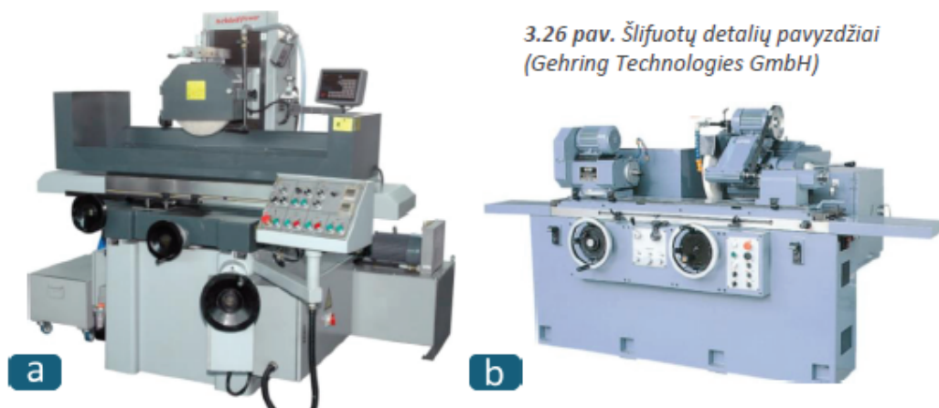
3.27 pav. Šlifavimo staklės: a) plokščiojo šlifavimo SCHLEIFPOWER FSM 30100 AHD staklės (HESSE+CO Maschinenfabrik GesmbH), b) apvaliojo šlifavimo AJG27 staklės (Ajax Machine Tool Company, Ltd.)
